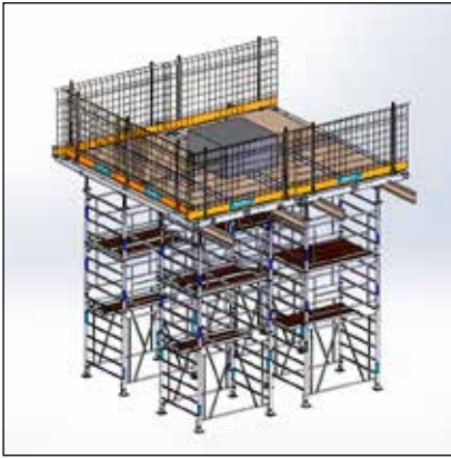
- Einsetzen des Ballasts für die Wandschalung.
