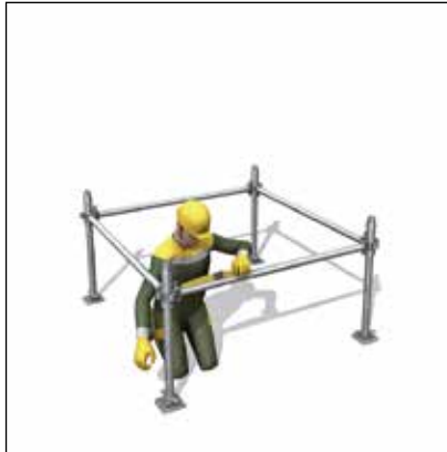
- Aufbau und waagrechte Ausrichtung
