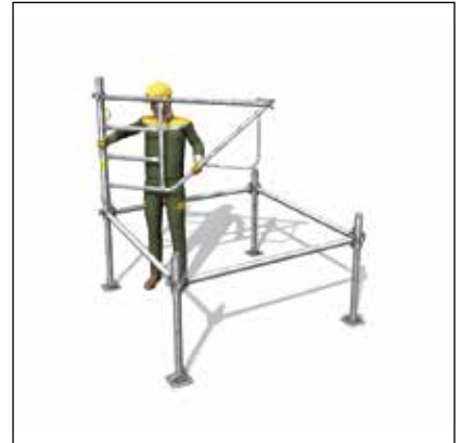
- Den ersten Rahmen vom Inneren des Turms aus in der Achse der Diagonale einsetzen und dann zum Verriegeln drehen.
