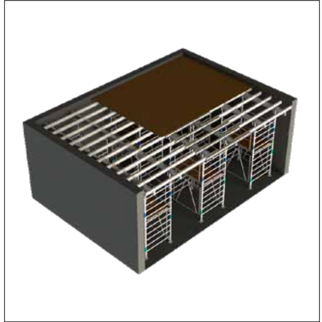
- Abstützung für vor Ort gegossene Decke mit AL200 auf Gerüstturm A120.
